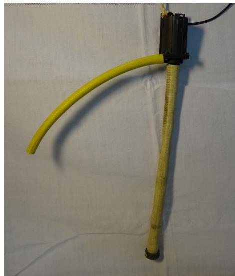
Après de nouveaux tests, on s'aperçoit que la température de l'eau est homogène grâce à la pompe. Grâce au variateur, on peut contrôler la température à + ou – deux degrés.
