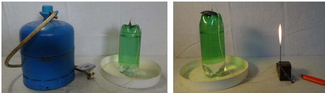
Remplissage de la cloche avec le butane, puis combustion du gaz
